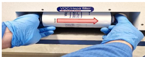
12.2 pav. LOJ ir HEPA filtro įdėjimo ir išėmimo procedūra
